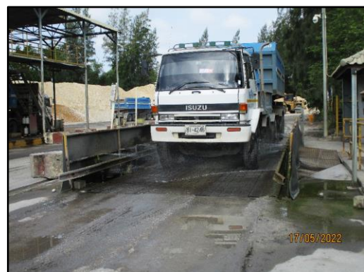
ภาพที่ 2.21 จุดล้างล้อรถบรรทุกทุกบริเวณด้านล่าง
