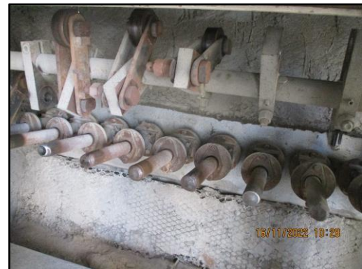
ภาพที่ 2.25 Casing หุ้มชุด Hammering Equipment ในหม้อไอน้ำ
