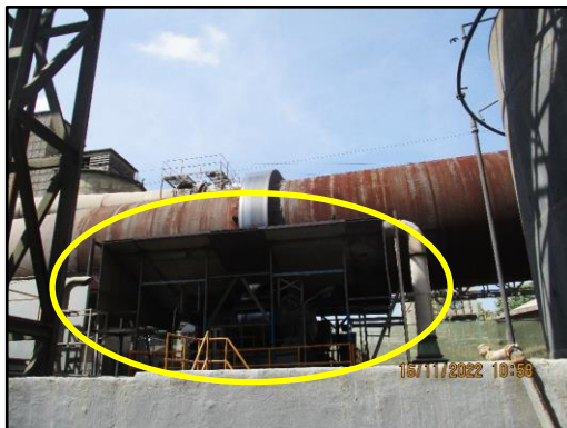
ภาพที่ 2.41 ฉากป้องกันความร้อนบริเวณ Riser pipe
